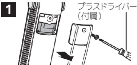
付属のプラスドライバーで本体背面のビスをはずしてカバーを開け、光触媒フィルターを取り出す
