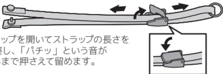
クリップを開いてストラップの長さを調整し、「パチッ」という音がするまで押さえて留めます。
