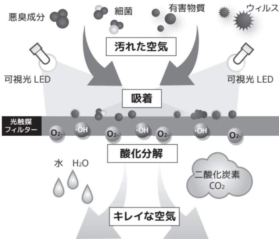
光触媒フィルターに光を照射すると、強力な酸化力を帯びるようになります。この光触媒が持つ強い酸化能力を利用して、空気中の悪臭成分や有害物質などを分解することができます。
