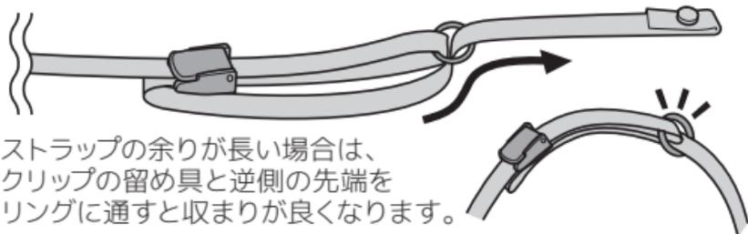
ストラップの余りが長い場合は、クリップの留め具と逆側の先端をリングに通すと収まりが良くなります。
