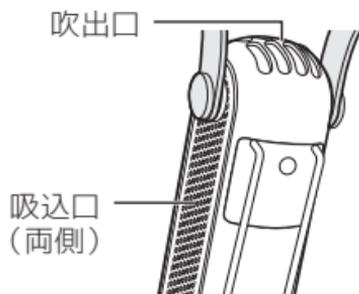
吸込口は、柔らかい布などで定期的に清掃してください。本体の汚れは乾いた柔らかい布で拭き取ってください。本体の汚れは消しゴムでも落とせます。
