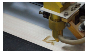
写真6：吉辰商店にてハンドルにカルテックの「K」ロゴをレーザーで1つ1つ加工
